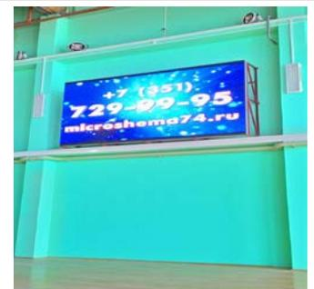
**Светодиодный экран, размер кабинета 1280мм\*640мм**
